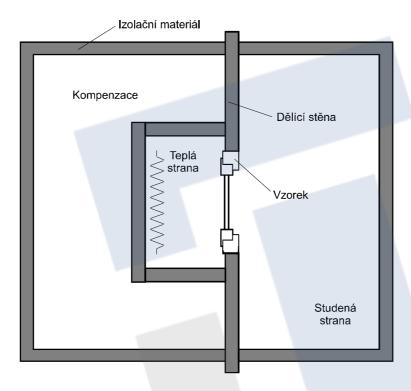
Key: Kompenzace: Compensation; D licí st na: Surround Panel; izola ní materiál: Insulating material; Vzorek: Specimen; Teplá strana: Warm side; Studená strana: Cold side figure1 - Testing equipment scheme
